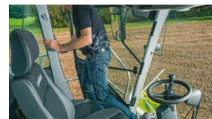
Sædekontakten kobler automatisk frontudstyret og hovedtrækket fra.
