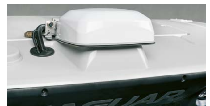
SAT 900 antenn och mottagare i samma enhet – med stölskydd.
