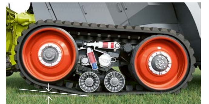
66 % kontaktyta: Löphjulet lyftes 100 mm uppåt vid körning i svängar.
