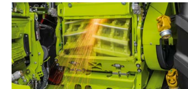
Schleifen und Einstellen der Gegenschneide nehmen kaum Zeit in Anspruch.
