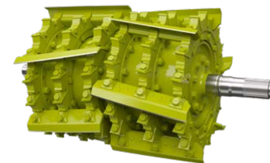
Schnittlängenerweiterung bei V-36 durch ein Drittel der Messeranzahl mit symmetrischer Erntegutabgabe.
