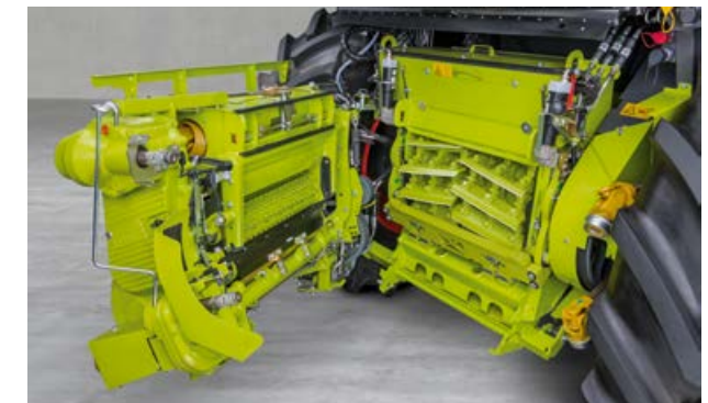
Leicht zugängliche Trommel für eine schnelle und einfache Wartung.
