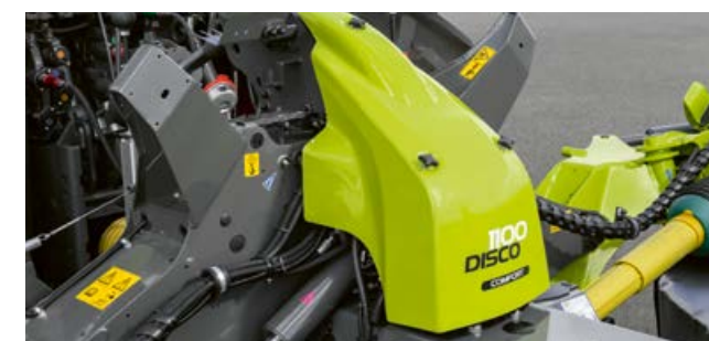
Compacte en stevige aanbouwbox met standaard geïntegreerd ACTIVE FLOAT ontlastingssysteem.
