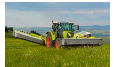
Door de compacte ophanging aan de fronthef beschikt de maaier over veel bodemvrijheid op de kopakker.
