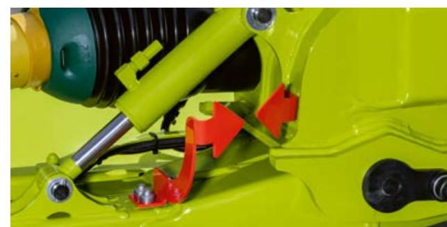
Eenvoudig instellen van hoogte aanbouwframe: pijlpunten moeten naar elkaar wijzen.
