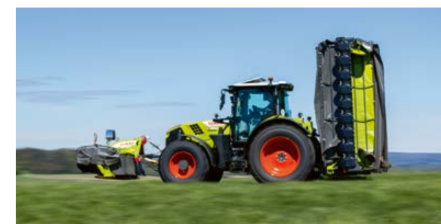
Compacte transportstand blijft onder 4 m voor veilige straatritten.
