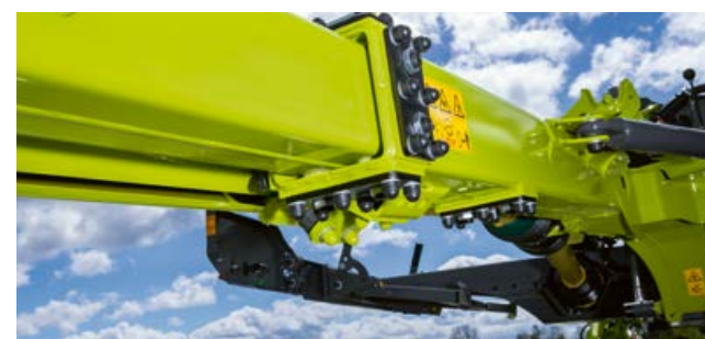
Twee hydraulisch regelbare telescooparmen met traploze instelling voor optimale overlap bij DISCO 1100 COMFORT.
