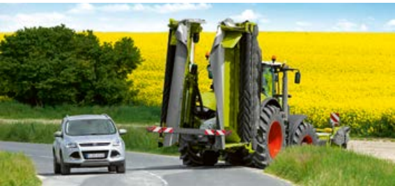
Moins de 4 m de hauteur : encombrement réduit en position de transport, avec une garde au sol généreuse sur les deux modèles BUSINESS
