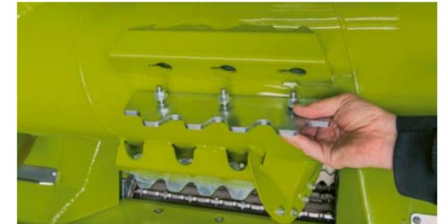
Komfortabel gelöst ist das Wechseln der Leisten auf den Förderpaddeln. Für einen reibungslosen Gutfluss bei geringen Erntemassen werden erhöhte, gezahnte Förderleisten empfohlen.
