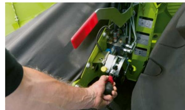
Dreistufige Drehzahlanpassung der Einspeisetrommeln für optimalen Gutfluss.
