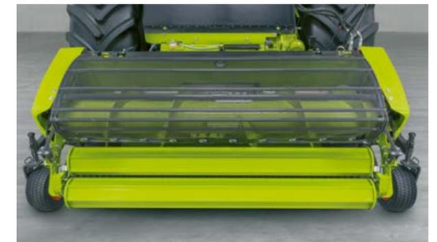
Für den Transport werden die Tasträder eingeklappt. Dies erfolgt entweder mechanisch und werkzeuglos oder komfortabel mit einem Knopfdruck aus der Kabine heraus.
