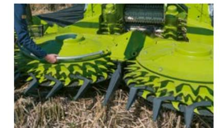
Demontage der Kolbenfallen erhöht die Gutflusstauglichkeit.
