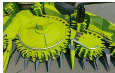
Sicherer Pflanzentransport in den Gutflusskanälen.
