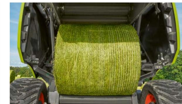
Sur la presse ROLLANT 540, la porte arrière s'ouvre et se referme automatiquement en six secondes seulement dès que le tracteur est au point mort. Mais ce n'est pas le seul atout confort pour le conducteur : cycle de nettoyage et désactivation automatiques des couteaux, sélection des couteaux depuis la cabine, tout a été conçu pour lui faciliter le travail.
