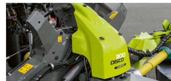
Kompaktowy i stabilny zaczep z seryjnie montowanym systemem odciążenia ACTIVE FLOAT.
