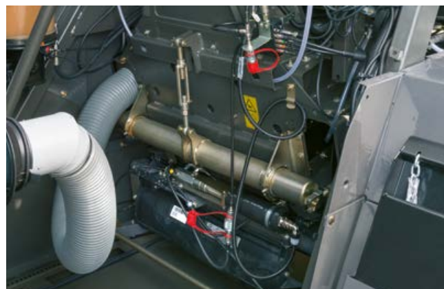
Mechanické nastavení mezery metače pro odhoz řezanky
