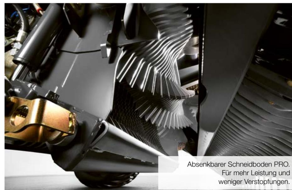
Absenkbare Schneidboden PRO. Für mehr Leistung und weniger Verstopfungen.
