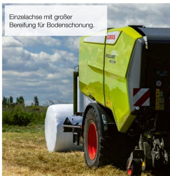
Einzelachse mit großer Bereifung für Bodenschonung.
