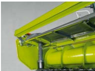
Rouleau tasseur pour une alimentation régulière de l'ensileuse.
