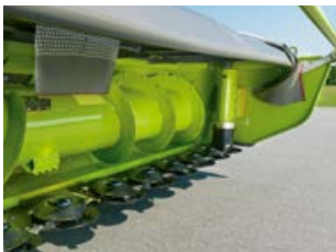
DIRECT DISC 600 / 500 avec vis sans fin d'alimentation de grand diamètre.
