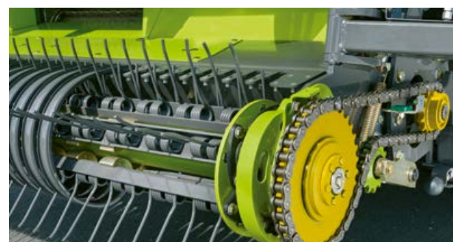
Pick-up robuste pour un ramassage propre du fourrage.
