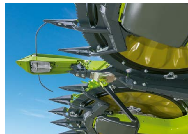
Копіювальний пристрій AUTO CONTOUR, постачається для ORBIS 900.
