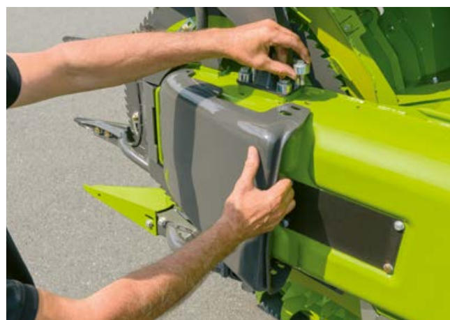
Ковзні башмаки з двоступінчастим регулюванням за висотою.
