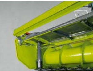
Роликові притискачі для дуже рівномірної подачі рослинної маси.
