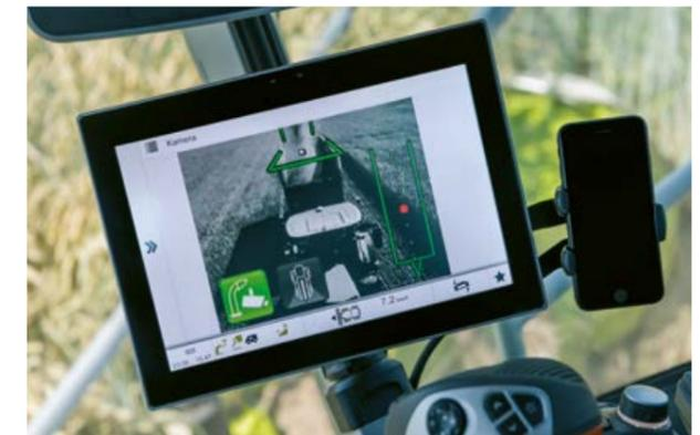
**AUTO FILL para el relleno automático de remolques.**
