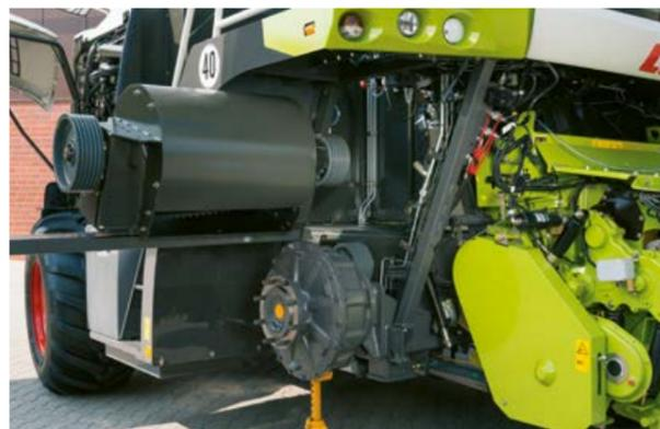
Sencillo desmontaje y montaje del acelerador
