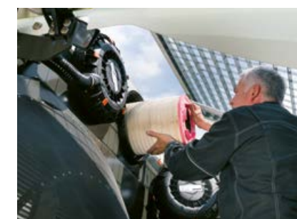
Wymiana filtra powietrza bez użycia narzędzi.
