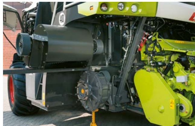
Łatwy montaż i demontaż przyspieszacza.
