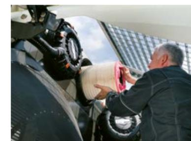
Sostituzione senza attrezzi del filtro dell'aria.
