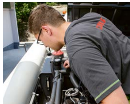
Einfache Sichtkontrolle aller Ölstände
