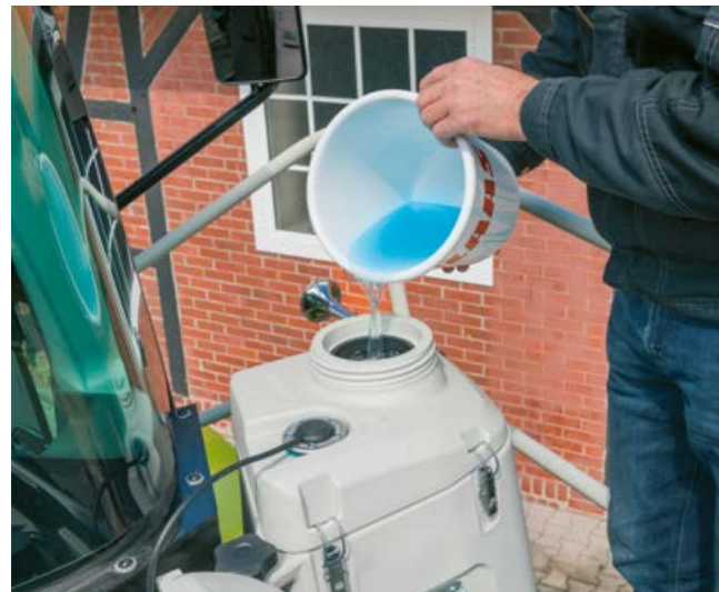
Befüllen des Siliermitteltanks
