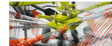
Enganche cardánico de los rotores: Los rotores se adaptan al suelo – independientemente del tractor.
