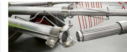
Cómodo montaje y desmontaje de los brazos de púas: El seguro patentado de portapúas PROFIX con dentado múltiple.
