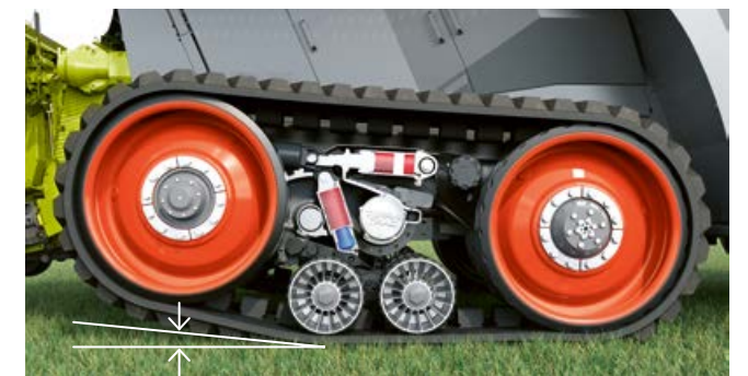
66% Aufstandsfläche: Die Laufrolle wird bei Kurvenfahrten angehoben.
