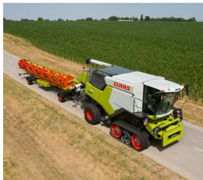
Alla TERRA TRAC bandställ är godkända för körning på väg i upp till 30 km/h och är mera behagliga att köra än hjulmaskinerna.
