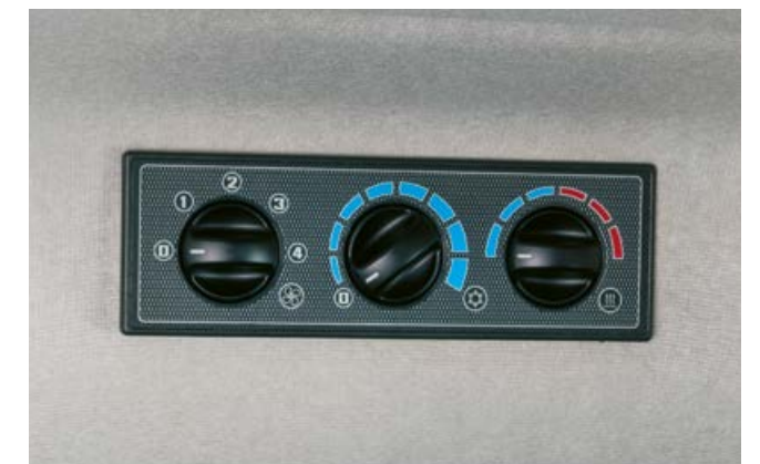
A szellőzőrendszer kezelőszervei a jobb oldalon, a tetőkárpitban könnyen hozzáférhetőek.
