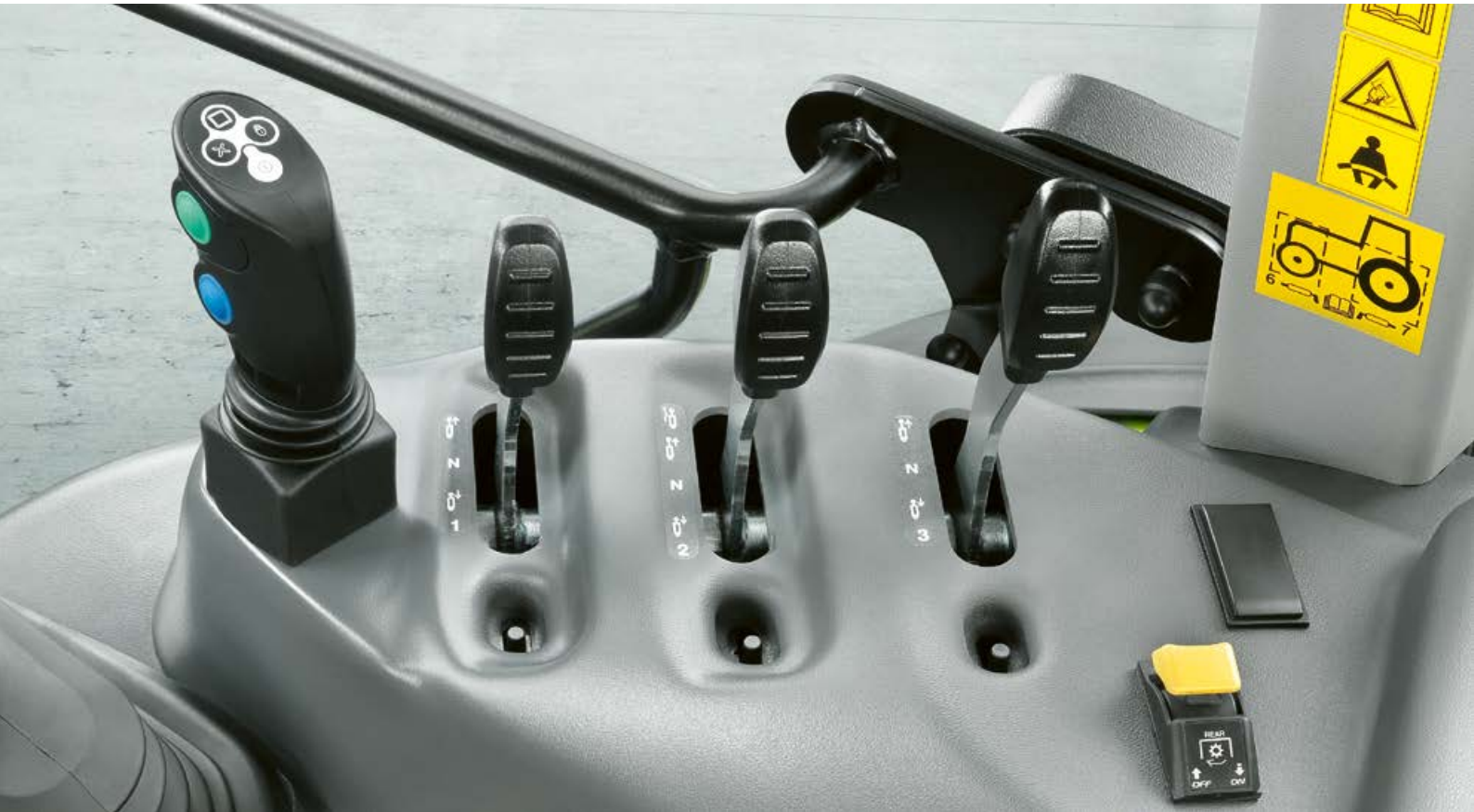
A 3. mechanikus kihelyezett kör maximális áramlási sebessége a fülkében található forgókapcsolóval állítható.
