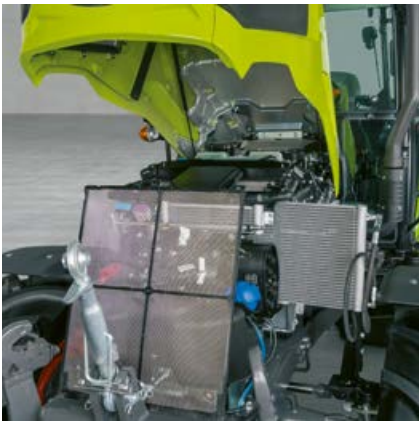
A hűtő pillanatok alatt kihúzható, és a szűrő eltávolítható ellenőrzés és tisztítás céljából.
