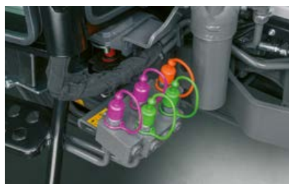
Elöl akár négy hidraulikus csatlakozó és egy szabad visszafolyó ág is rendelkezésre áll.
