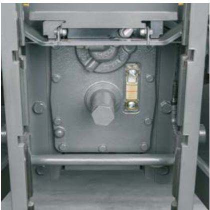
Ellenőrizze a sebességváltó és a hidraulika olajsintjét a hátsó mellékajátás csomja melletti látóüvegen keresztül.
