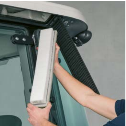
A fülke légszűrője kívülről könnyen hozzáférhető a tisztításhoz, és mindig friss klímát biztosít a fülkében.
