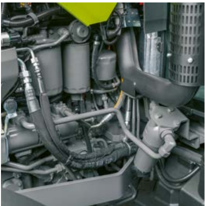
A motoron lévő szűrők is könnyen hozzáférhetők a homlokrakódó konzoloknál.
