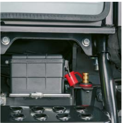
Az ELIOS 300 számos ötletes megoldást tartalmaz, amelyek megkönnyítik a mindennapi munkát, például a fülke jobb oldalán található, könnyen hozzáférhető akkumulátorcsatlakozókat.
