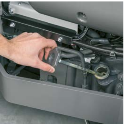
Az olajsint ellenőrzése és feltöltése az ELIOS 300 jobb oldalán történik, amikor a motorháztető zárva van.
