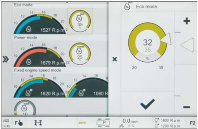
Réglage du droop moteur pour les modes « Eco » et « Power » ainsi que pour la mémoire moteur.
