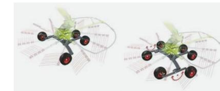
Ideale Zinkenführung: Dafür sorgt das Kreiselfahrwerk, welches so nah wie möglich an den umlaufenden Zinken positioniert ist.
