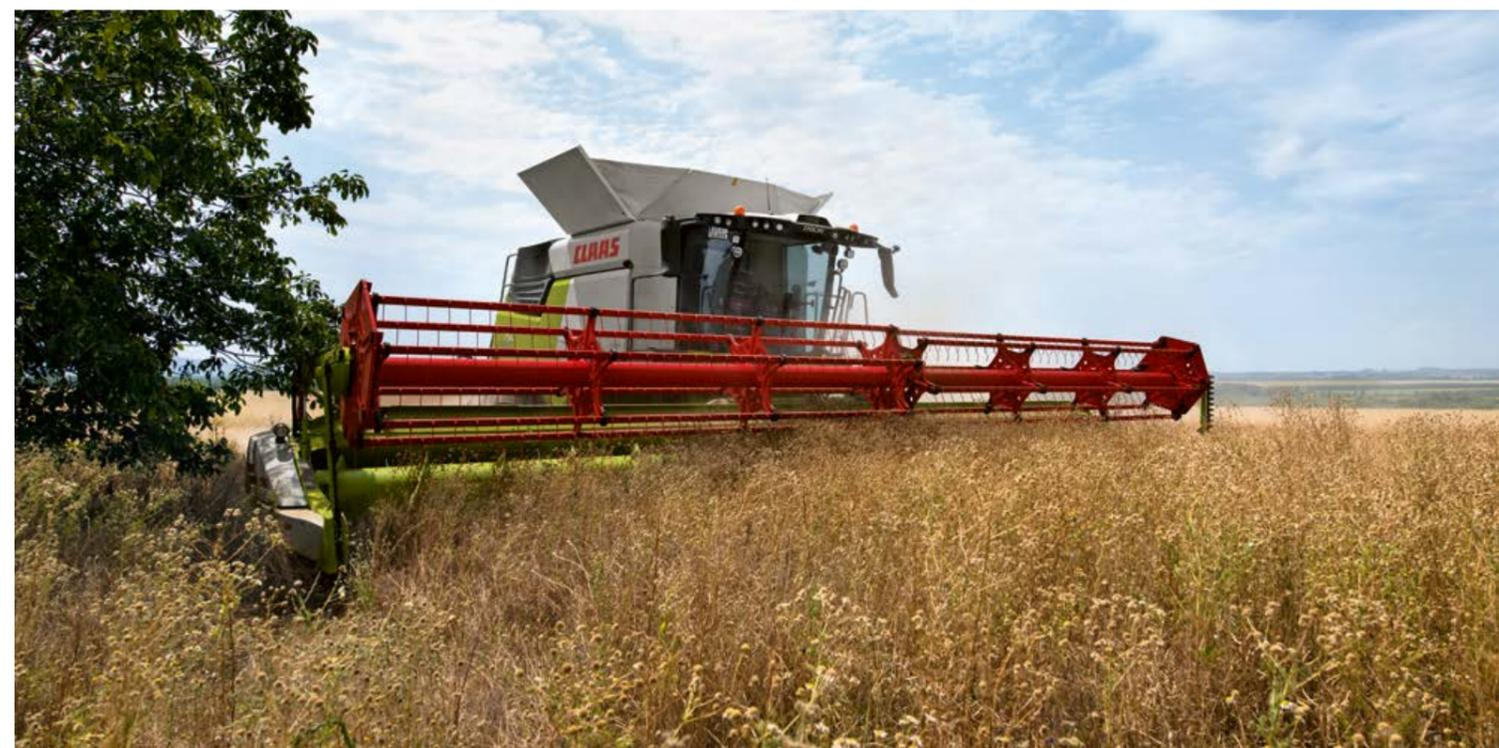
**Il rilevamento automatico della testata fa risparmiare tempo.** La TRION imposta automaticamente i parametri fondamentali. A tal scopo, il modulo della testata fornisce le seguenti informazioni: tipo di piattaforma di taglio, larghezza di lavoro, numero di larghezze parziali, posizione dell'aspo, posizione di stazionamento e valori nominali AUTO CONTOUR per altezza di lavoro e contatore ettari.
