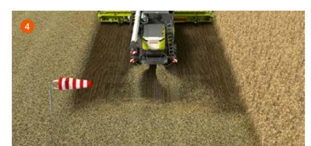
3 Sensori installati sul retro della macchina rilevano l'intensità del vento laterale.
