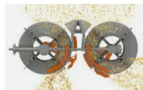
Radialverteiler für effiziente Strohverteilung bei minimalem Kraftaufwand
