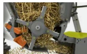
Gegenmesser und schwenkbares Bodenelement im SPECIAL CUT Häcksler
