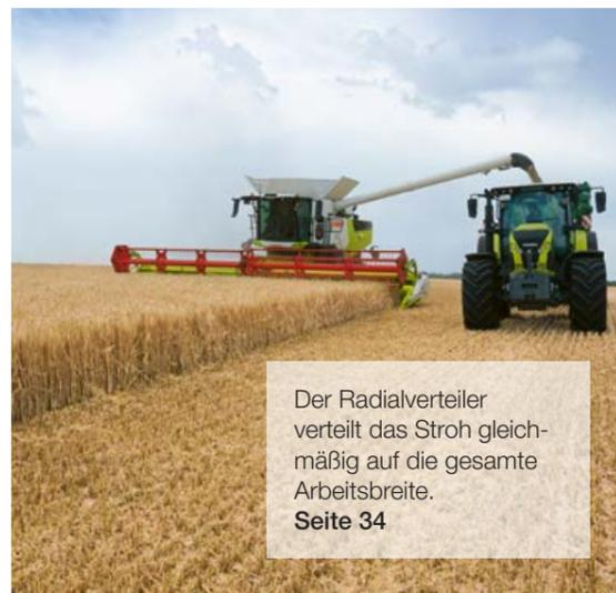
Der Radialverteiler verteilt das Stroh gleichmäßig auf die gesamte Arbeitsbreite. **Seite 34**
