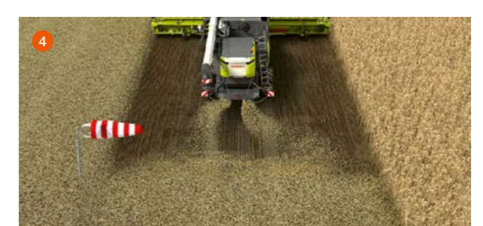
3 Senzori na stražnjem dijelu stroja mjere jačinu bočnog vjetra. 4 Kut bacanja usitnjenog materijala se time nadoknađuje.
