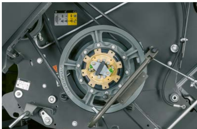
Brzina okretaja sjeckalice za slamu može se lako, brzo i bez alata prilagoditi vašoj primjeni.
