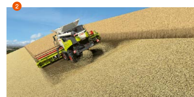
1 Ako postoji nagib, smjer bacanja automatski se podešava. 2 Sjeckani materijal ravnomjerno se raspoređuje po cijeloj radnoj širini.
