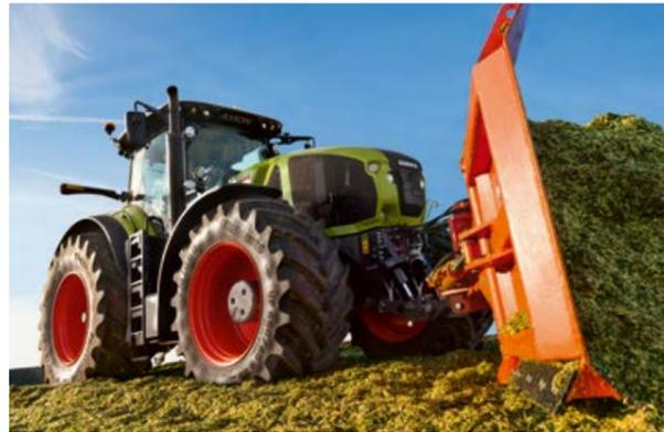
В сочетании с фронтальной навеской с передней стороны доступно до двух контроллеров двойного действия и одна безнапорная возвратная линия. Идеально для бункера посевного материала или грейдера для фронтальной навески.
