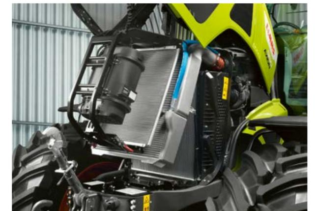
Легкодоступный воздушный фильтр расположен с холодной стороны радиатора и может быть извлечен без каких-либо сложностей. Благодаря системе отсасывания крупных загрязнений в корпусе фильтра значительно увеличивается интервал очистки.
