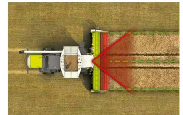
LASER PILOT avec FIELD SCANNER
