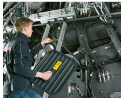
Points d'ancrage multiples pour l'échelle mobile
