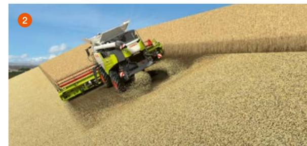
1 Ajustement automatique de la direction d'épandage en dévers
