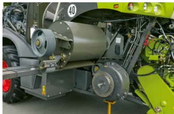
Einfacher Aus- und Einbau des Beschleunigers
