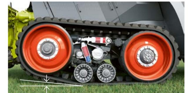
66% Aufstandsfläche: Die Laufrolle wird bei Kurvenfahrten angehoben.
