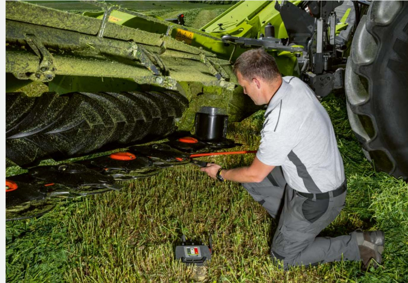
I coltelli di ricambio sono conservati in una scatola antipioggia sulla falciatrice, per facilitarne la sostituzione direttamente sul campo. I coltelli possono essere sostituiti in modo rapido e semplice utilizzando la leva di montaggio integrata nella falciatrice.
