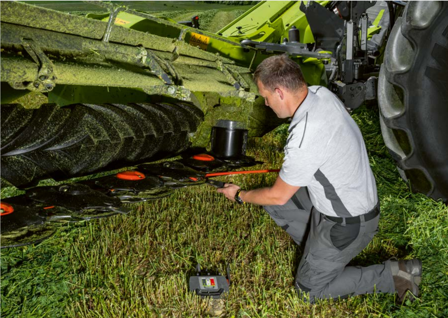
Cuțitele de schimb sunt depozitate pe cositoare într-o cutie rezistentă la intemperii, facilitând schimbarea lor direct pe teren. Cuțitele pot fi înlocuite rapid și ușor folosind levierul integrat în cositoare.
