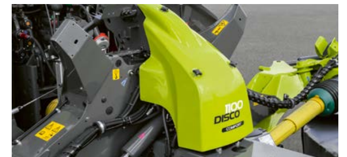
Bloc de montare compact, robust, cu sistem de suspensie ACTIVE FLOAT integrat, disponibile standard.
