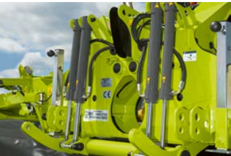
Cilindrii standard de ridicare și de suspensie ai suspensiei ACTIVE FLOAT asigură protecție fiabilă pentru iarbă.
