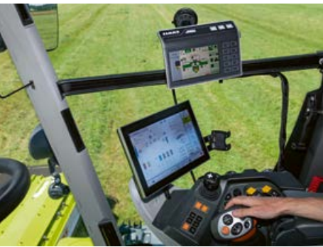
Operare ușoară, de exemplu cu ajutorul diferitelor terminale ISOBUS și tastelor funcționale ISOBUS de pe maneta de comandă.
