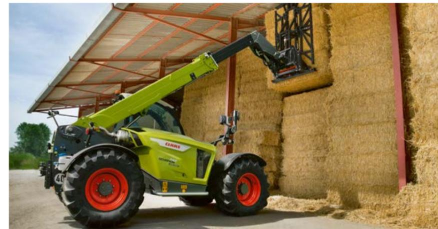
◀ Con el control de precisión para el sistema hidráulico de trabajo coloca los materiales apilables, también a una gran altura, con gran precisión y trabaja de forma exacta al manipular materias peligrosas o cargas pesadas. Usted pulsa únicamente el interruptor y ya se reduce automáticamente la velocidad de la instalación hidráulica de trabajo a la mitad.
