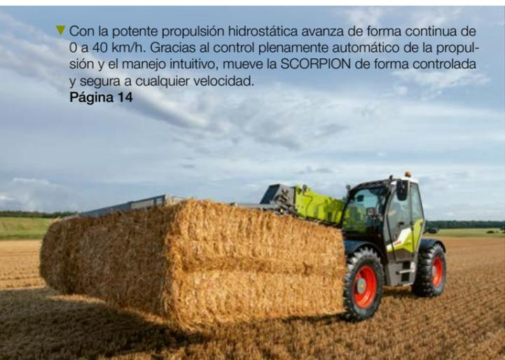
▼ Con la potente propulsión hidrostática avanza de forma continua de 0 a 40 km/h. Gracias al control plenamente automático de la propulsión y el manejo intuitivo, mueve la SCORPION de forma controlada y segura a cualquier velocidad.
