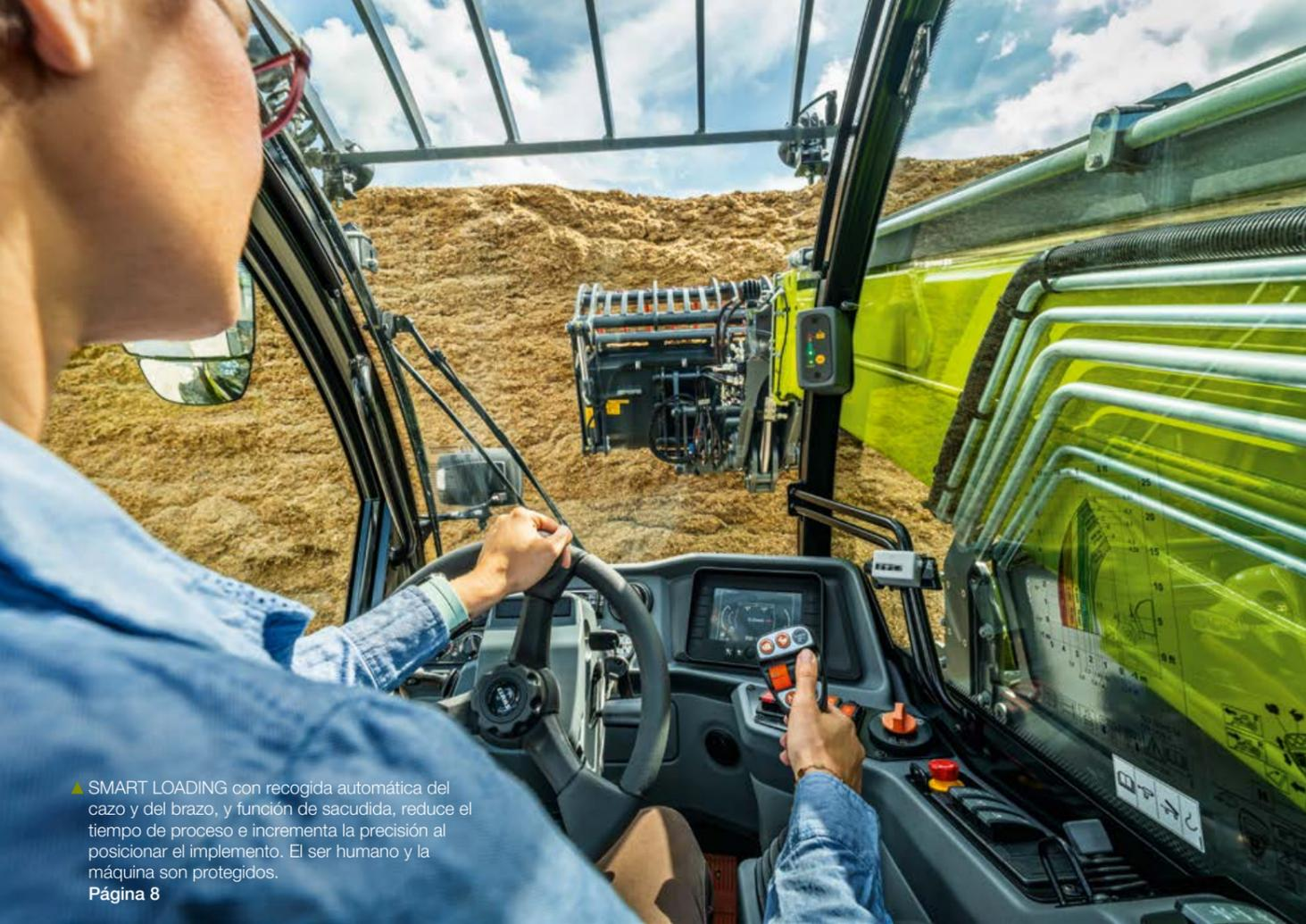
▲ SMART LOADING con recogida automática del cazo y del brazo, y función de sacudida, reduce el tiempo de proceso e incrementa la precisión al posicionar el implemento. El ser humano y la máquina son protegidos.
