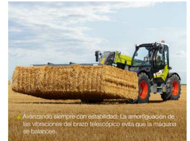
▲ Avanzando siempre con estabilidad. La amortiguación de las vibraciones del brazo telescópico evita que la máquina se balancee.
