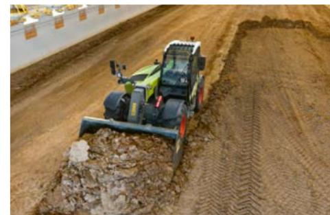
◀ Recogida automática del cazo. Grabe fácilmente una posición deseada del cazo y actívela cómodamente pulsando un botón en el joystick.
