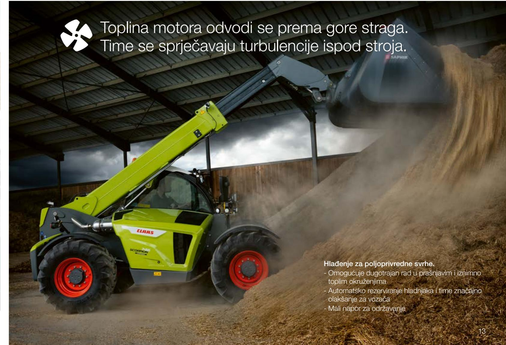
Toplina motora odvodi se prema gore straga. Time se sprječavaju turbulencije ispod stroja.
