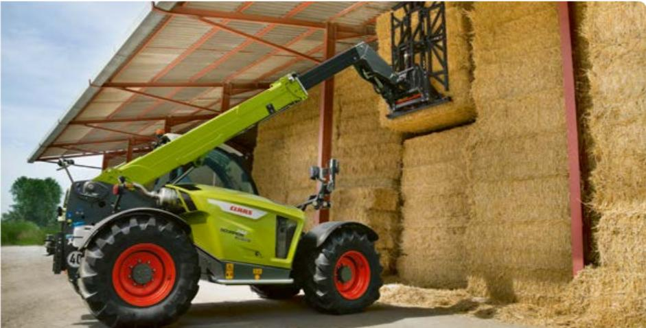
► Uz finu kontrolu radne hidraulike, možete precizno postaviti naslaganu robu čak i na velikim visinama i pažljivo raditi s opasnom robom ili teškim teretom. Sve što trebate učiniti je pritisnuti prekidač i brzina radne hidraulike automatski se smanjuje za pola.
