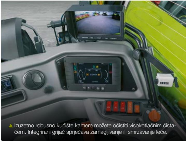
▲ Izuzetno robusno kućište kamere možete očistiti visokotlačnim čistačem. Integrirani grijač sprječava zamagljivanje ili smrzavanje leće.
