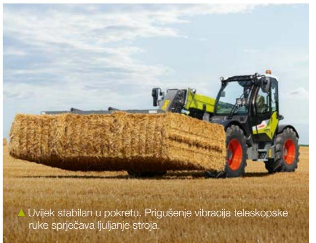
▲ Uvijek stabilan u pokretu. Prigušenje vibracija teleskopske ruke sprječava ljuštanje stroja.
