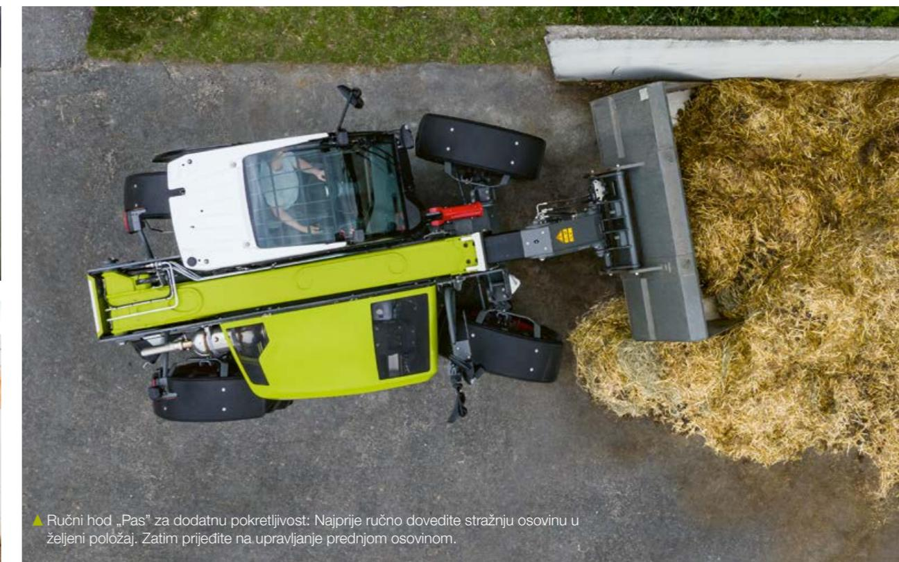
▲ Ručni hod „Pas“ za dodatnu pokretljivost: Najprije ručno dovedite stražnju osovinu u željeni položaj. Zatim priđite na upravljanje prednjom osovinom.
