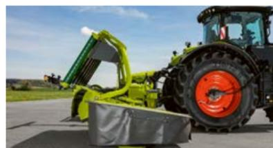
Cuando no se necesitan las cintas, giran hacia delante, por encima de las unidades segadoras, de manera que el centro de gravedad se desplaza hasta muy cerca del tractor.
