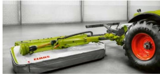
Con brazos salientes conmutables hidráulicamente se logra, dependiendo de la segadora frontal, una anchura de trabajo entre 9,40 m y 10,70 m.
