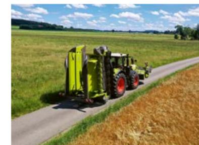
Compacta posición de transporte para una segura conducción por carretera.
