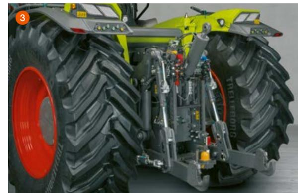
**Capacità di sollevamento di 13,6 t sulla parte posteriore.**
