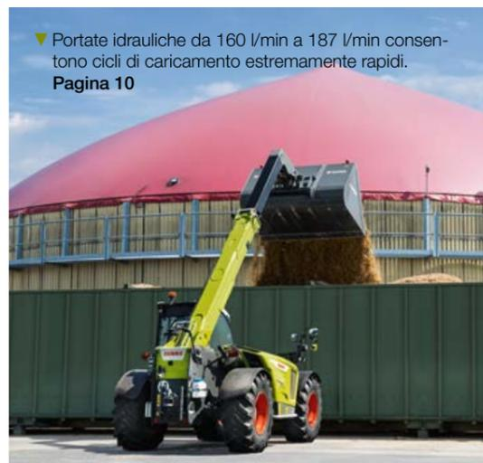
▼ Portate idrauliche da 160 l/min a 187 l/min consentono cicli di caricamento estremamente rapidi.
