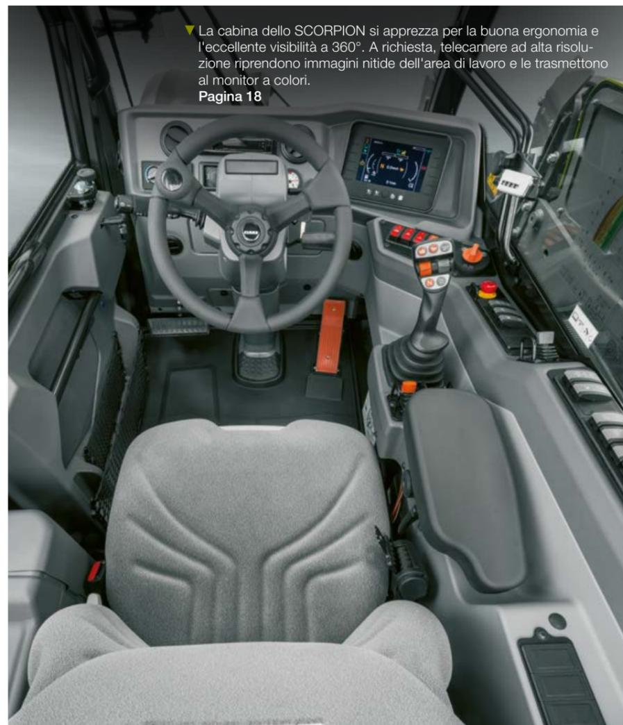
▼ La cabina dello SCORPION si apprezza per la buona ergonomia e l'eccellente visibilità a 360°. A richiesta, telecamere ad alta risoluzione riprendono immagini nitide dell'area di lavoro e le trasmettono al monitor a colori.
