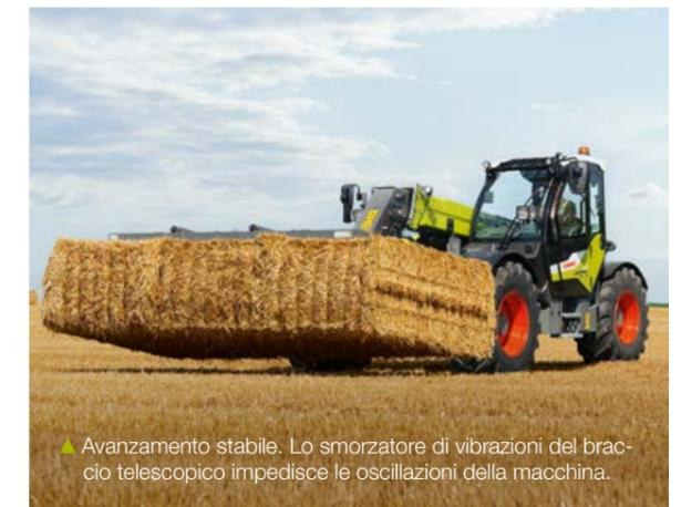
Avanzamento stabile. Lo smorzatore di vibrazioni del braccio telescopico impedisce le oscillazioni della macchina.
