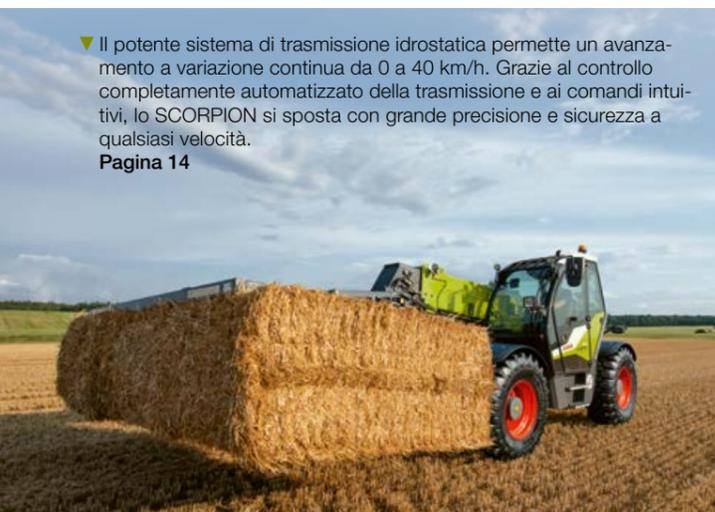
▼ Il potente sistema di trasmissione idrostatica permette un avanzamento a variazione continua da 0 a 40 km/h. Grazie al controllo completamente automatizzato della trasmissione e ai comandi intuitivi, lo SCORPION si sposta con grande precisione e sicurezza a qualsiasi velocità.
