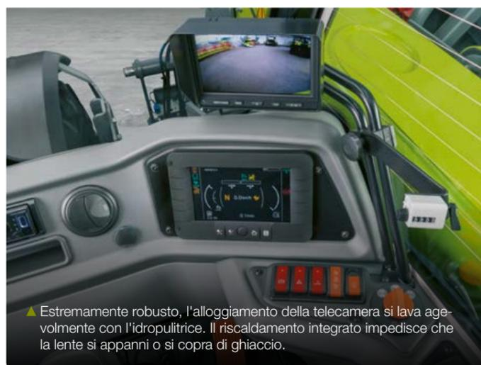
▲ Estremamente robusto, l'alloggiamento della telecamera si lava agevolmente con l'idropulitrice. Il riscaldamento integrato impedisce che la lente si appanni o si copra di ghiaccio.
