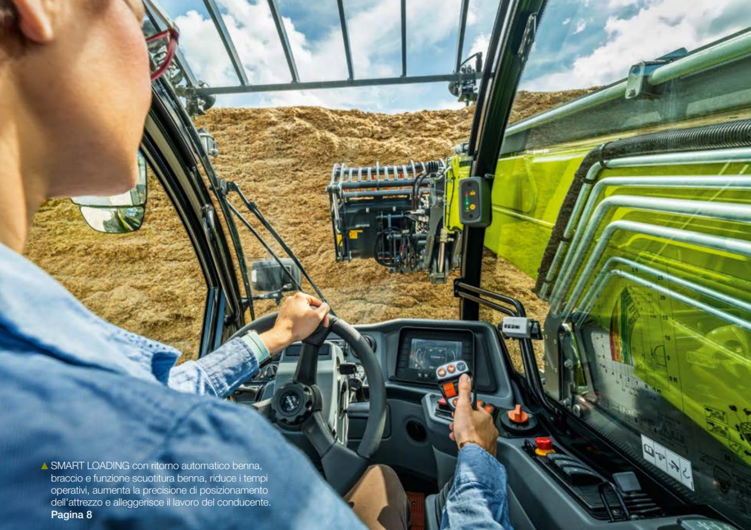
▲ SMART LOADING con ritorno automatico benna, braccio e funzione scuotitura benna, riduce i tempi operativi, aumenta la precisione di posizionamento dell'attrezzo e alleggerisce il lavoro del conducente.
