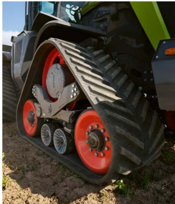
▼ « Les chenilles TERRA TRAC spécialement conçues pour le XERION par CLAAS transmettent parfaitement et en douceur la puissance au sol. »
