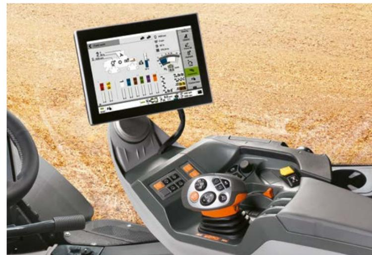
▲ Le CEMOS permet aux conducteurs même inexpérimentés de piloter parfaitement le tracteur et l'outil pendant toute la durée du chantier. Le système d'assistance au conducteur offre une aide permanente, du lestage et de la pression de gonflage des pneumatiques avant l'application prévue dans le champ à l'optimisation des réglages du moteur et de la transmission pendant le travail.
