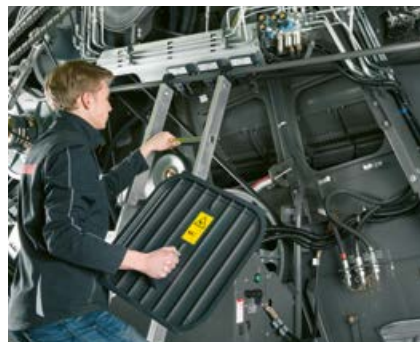
Багато точок кріплення для переносної драбини
