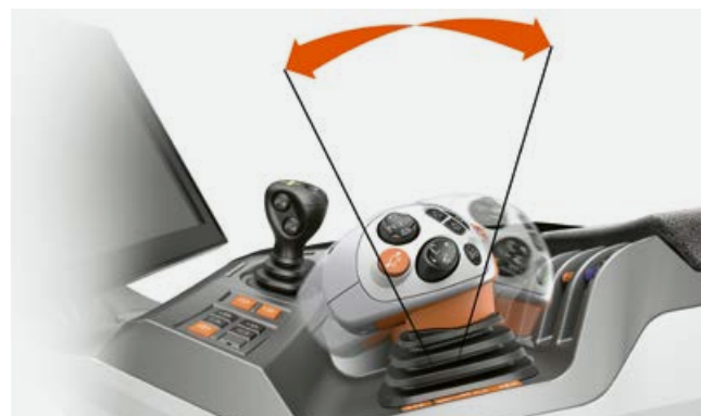
Progresivní ovládání s technologií plynulé převodovky CMATIC.
