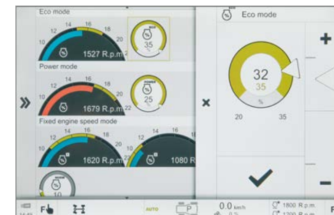
Nastavení dodávky paliva pro „Eco“ a „Power“, i pro paměť otáček motoru
