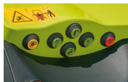
Externí ovládání zadního vývodového hřídele na obou blatnících.
