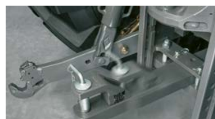
Varianty tažné lišty nabízí více pozic. Vytažená pozice vylepšuje obratnost.
