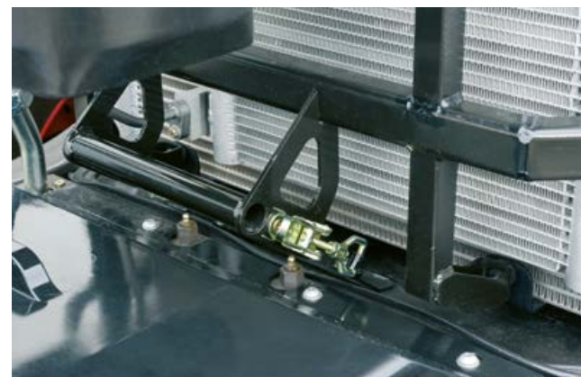
Místa k mazání přední nápravy před chladiči jsou optimálně přístupná.
