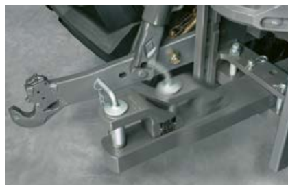
รูนคานลาก สามารถจัดวางตำแหน่งได้หลายรูปแบบ ตำแหน่งระยะยืนยาวจะเพิ่มความคล่องตัว
