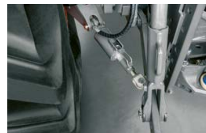
ตัวเลือกกันสะเทือนระบบไฮดรอลิกด้านข้าง ปลอดภัยยิ่งขึ้นและช่วยแบ่งเบาภาระงาน
