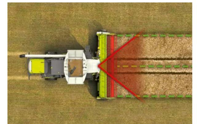
LASER PILOT con FIELD SCANNER
