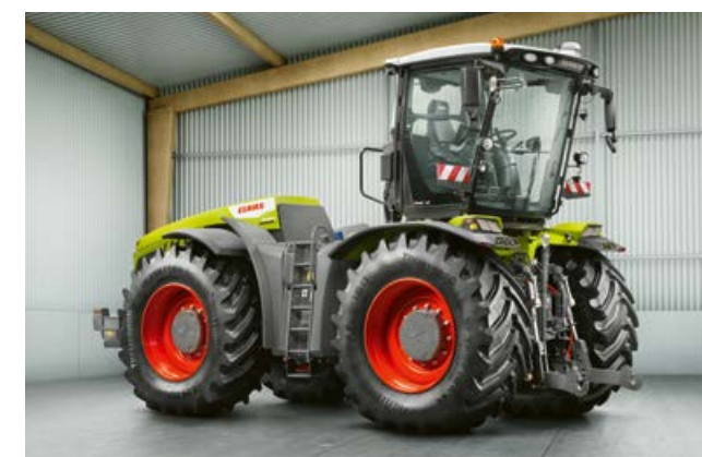
TRAC VC disponuje nejkomfortnější řešení otočného řízení na trhu. Jeho kabina se otočí během méně než 30 sekund o 180°.
