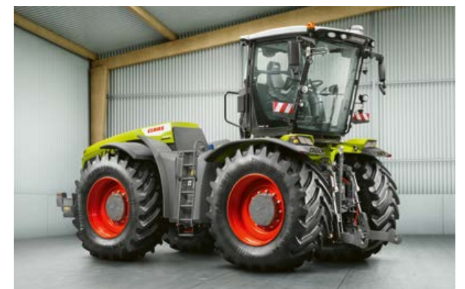
TRAC VC įrengta patogiausia rinkoje atbulinės eigos sistema. Kabiną galima pasukti 180° mažiau nei per 30 sekundžių.
