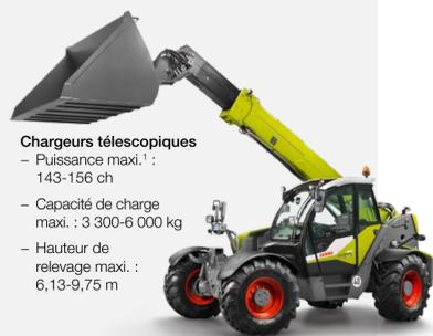
Chargeurs télescopiques - Puissance maxi.<sup>1</sup> : 143-156 ch
