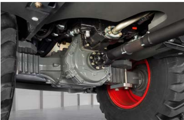
Hydrostatisk transmission med selvhæmmende bremsevirkning
