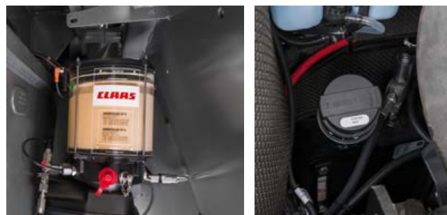
Oliepåfyldningsstuds til hydraulikolien er anbragt i et rent område under motorhjælmen. Oliestanden er umiddelbart let at aflæse gennem et godt synligt kontrolglas.
