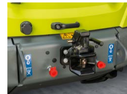
TORION 956 SINUS fås som ekstraudstyr med trykløst hydraulisk returløb i bagenden
