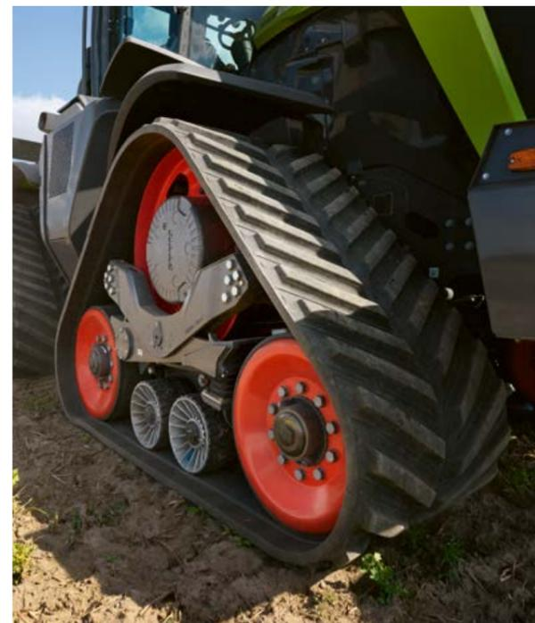
▼ »Das von CLAAS speziell für den XERION entwickelte TERRA TRAC Raupenlaufwerk überträgt die Kraft effizient und schonend auf den Boden.«
