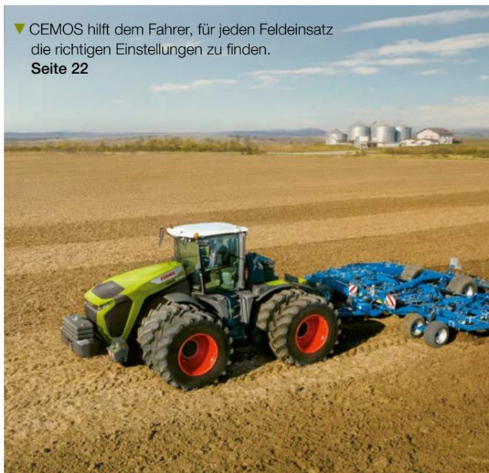
▼ Dank des modularen Konzepts, mit dem Sie den XERION schnell und einfach für die unterschiedlichen Einsätze passend ballastieren können, ist er immer nur so schwer, wie er unbedingt sein muss.
