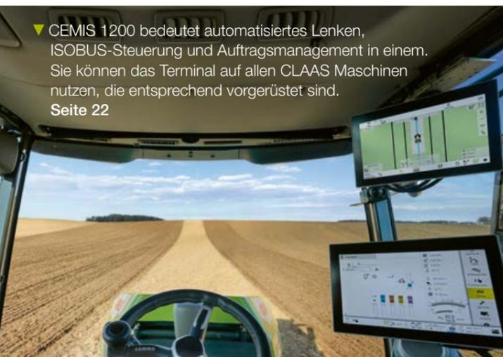
▼ CEMIS 1200 bedeutet automatisiertes Lenken, ISOBUS-Steuerung und Auftragsmanagement in einem. Sie können das Terminal auf allen CLAAS Maschinen nutzen, die entsprechend vorgerüstet sind.
