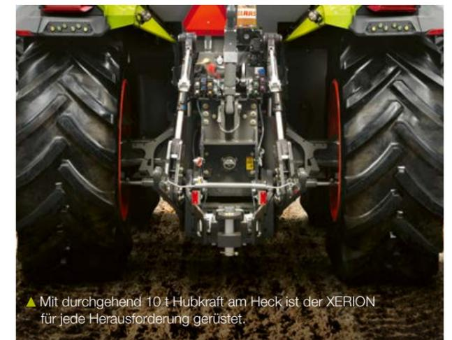
▲ Mit durchgehend 10 t Hubkraft am Heck ist der XERION für jede Herausforderung gerüstet.
