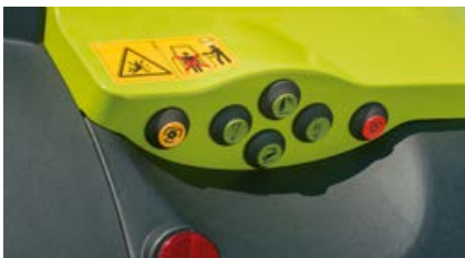
Controles externos para el elevador trasero, la toma de fuerza y un distribuidor hidráulico a elegir (solo CEBIS).
