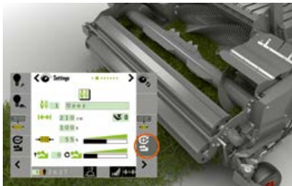
El POWER FEEDING SYSTEM también se puede invertir fácilmente desde la cabina del operario.
