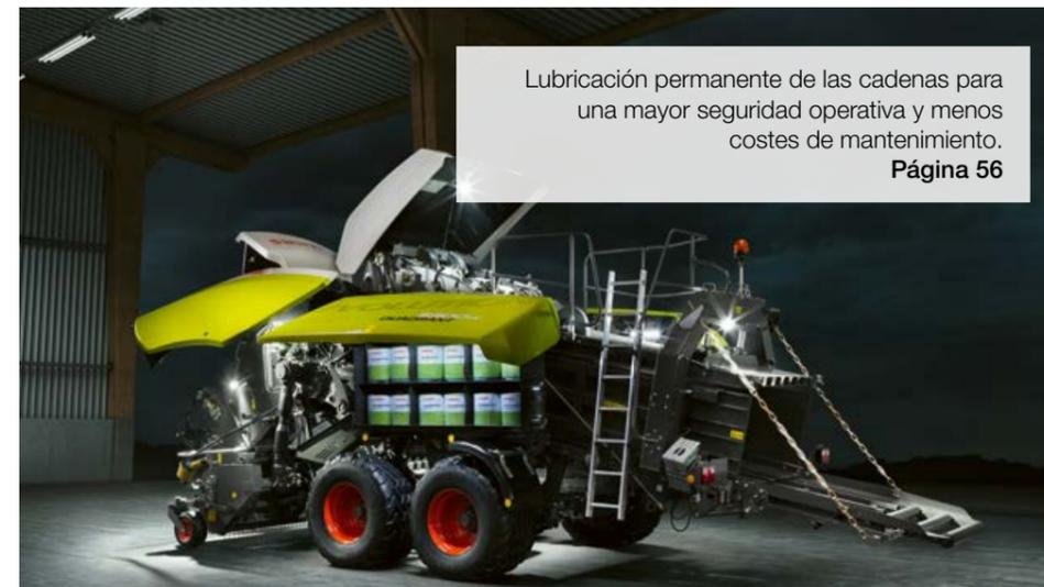
Lubricación permanente de las cadenas para una mayor seguridad operativa y menos costes de mantenimiento.
